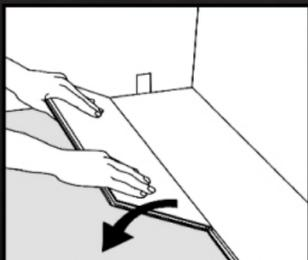
5. La segunda fila de piso y el suelo mantienen un bisel de 30° y se insertan en la fila anterior. Dóblalo hacia abajo y empujelo hacia adelante para que quede ajustado.
