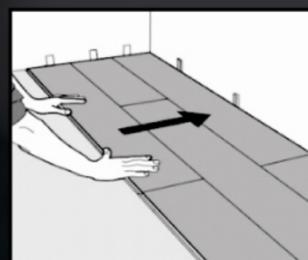
9. Después de instalar las primeras 2 o 3 filas de tablonos, se deben revisar con una línea, para asegurarse que las filas aún estén rectas. De no ser así, puede ser que la pared de partida tenga algunas irregularidades.
