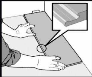
1. Instale desde la esquina de la pared, coloque el tablón contra la pared y use espaciadores para mantener la distancia entre el piso y la pared a 6 mm.
